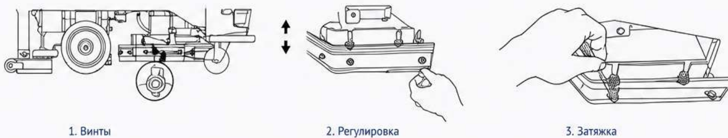
Рисунок 60 — Регулировка водоудерживающей юбки
